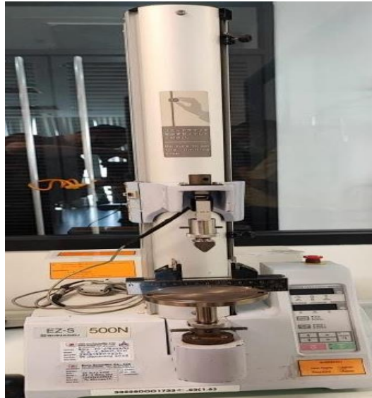
Fig. 2: Universal testing machine, shimadzu EZ-S 500N
